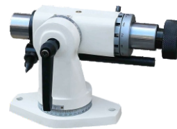
50D Заточный аппарат для лезвий торцевой фрезы
