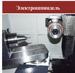
На электрошпиндель можно устанавливать до 3 шлифовальных дисков.
